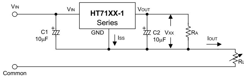
$$I_{OUT} = \frac{V_{XX}}{R_A} + I_{ss}$$
